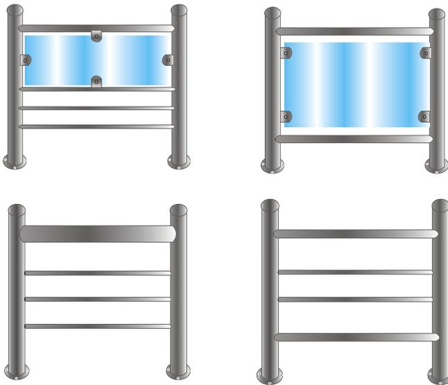
Portinholas e Fechamentos complementam um projeto de controle de acesso. Com estrutura modular em aço inox ou aço carbono pintado, com acabamentos metálicos ou com vidro temperado transparente de 8mm ou policarbonato, garante uma solução sofisticada e segura.
